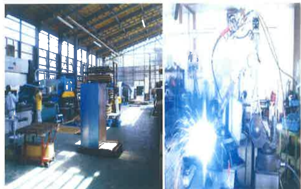
プレスブレーキで曲げ加工・ロボット溶接
